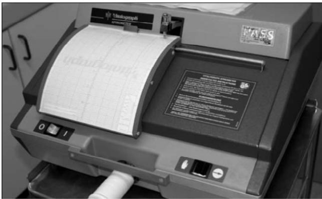
**Figura 4.** Un Vitalograph consta de un fuelle unidos a una pluma, con un motor, que mueve una hoja de papel debajo de la punta del lápiz, cuando el sujeto exhala y llena el fuelle. Una lectura típica se muestra en la Figura 5
