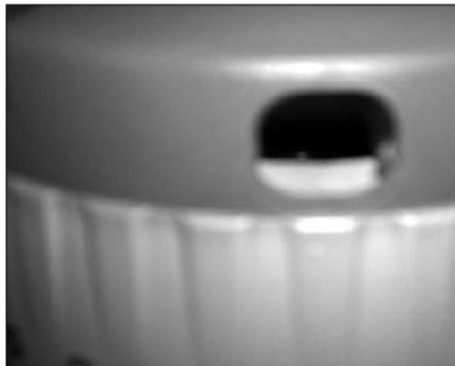
**Figura 2.** Halotano vaporizador con la punta fallada.
